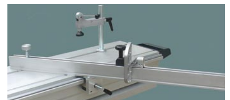
Optional: Präziser Gehrungsanschlag und manueller Schnellspanner.
