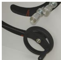
Proste ustawianie wysokości i przesuw w bok agregatu podcinacza.
