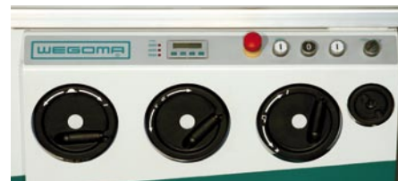
Bedienfront: Höheneinstellung, Winkeleinstellung, Verstellung Parallelanschlag
