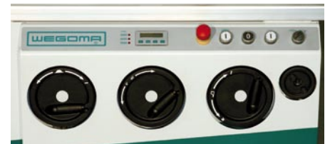
Frente de mando: Ajuste de altura, ajuste de ángulo, ajuste del tope paralelo
