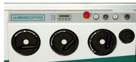
Parte anteriore di comando: Impostazione altezza, impostazione angolo, regolazione arresto parallelo
