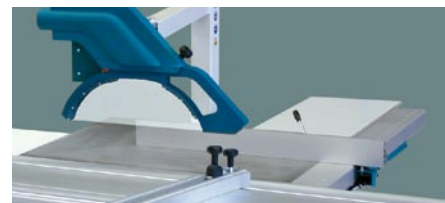
Arresto parallelo controllato elettricamente
