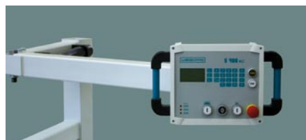
Pannello di comando con braccio basculante (S400NC)
