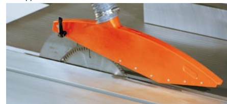
Cappa della sega fissata al cuneo separatore
