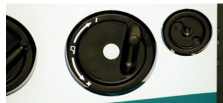
Настройка параметров параллельного упора с помощью маховиков
