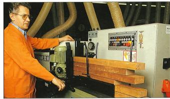
Este alimentador es apto para piezas de una longitud de 350 a 3000 mm, un ancho de 20 a 150 mm y una altura de 10 a 80 mm.
