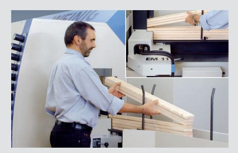
Магазины очень компактны, при их использовании меньше изнашивается режущий инструмент, легче работать оператору. А при наличии буферного запаса заготовок можно лучше организовать их контроль перед загрузкой.
