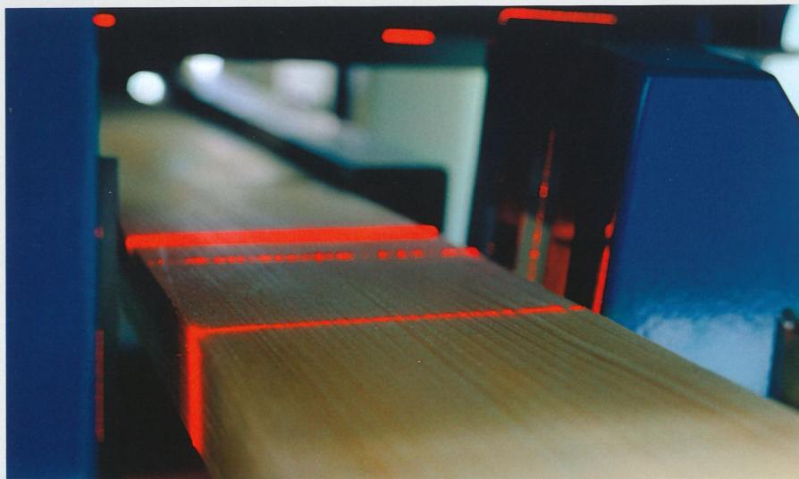
**Сканер** с молниеносной быстротой обследует поступающий на обработку материал и выявит на нём сучки, трещины, дефекты древесной структуры. Один такой прибор может снабжать соответствующими данными сразу четыре установки DIMTER OptiCut, работающие с полной нагрузкой и оснащённые высокоэффективными средствами механизации.
