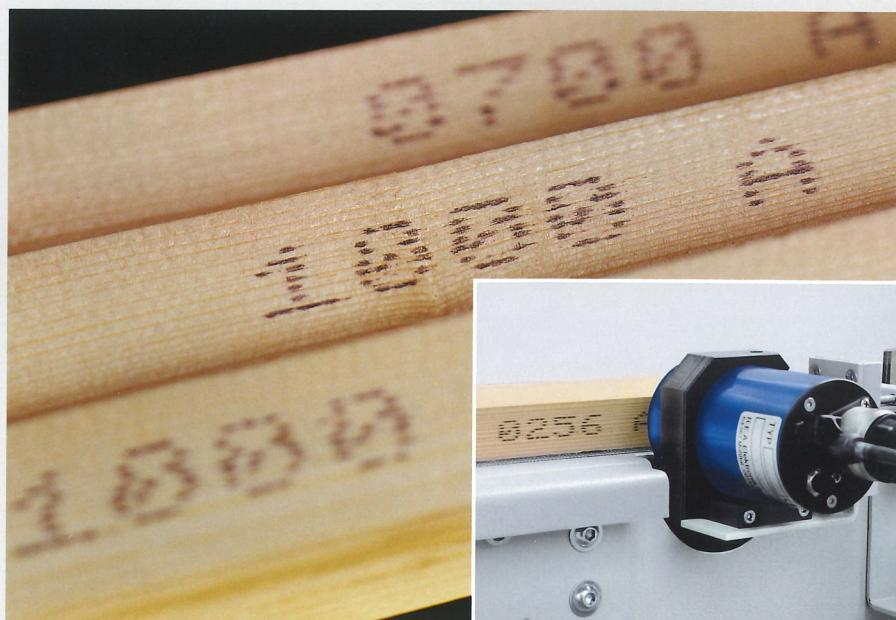
Кодирование деталей применяется для того, чтобы было легче отслеживать их распределение после прирезки, то есть идентифицировать каждую деталь при транспортировке, складском хранении или комплектовании заказов. Такой способ помогает снизить издержки, улучшить контроль продукции и в целом способствует внедрению рентабельных методов производства. Коды, цифровые или штриховые, наносятся прямо на детали – сбоку или сверху.
