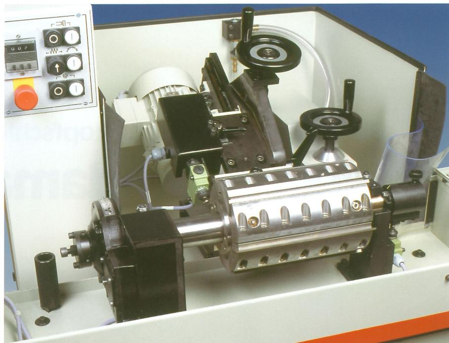
Automatisches Nachschärfen der Hobelmesser im Messerkopf mit konventioneller oder Hydro-Spannung
