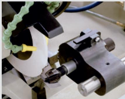
**Профилирование брусков джойнтера по шаблону –**
