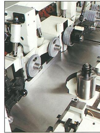
Der Tischaufbau ist komplett gehärtet. Das sichert eine hohe Verschleißfestigkeit.
