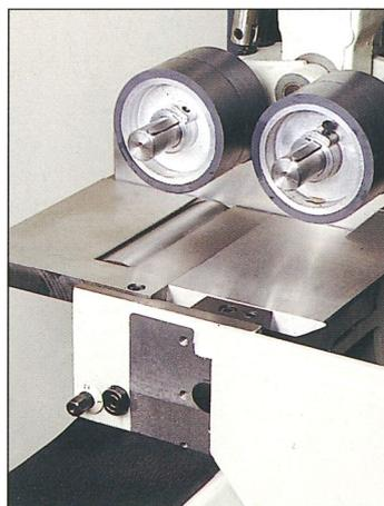
Verstellbarer Auslauf-tisch nach der unteren Profilierspindel. Schnell Rüsten. Keine Einschläge.
