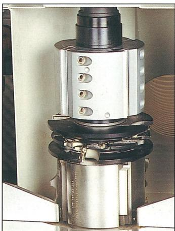
Hubspindel mit automatischer Steuerung der Hobhöhe und Vorwahl von Dicke und Breite. Beschleunigter Durchlauf in der Fertigung!
