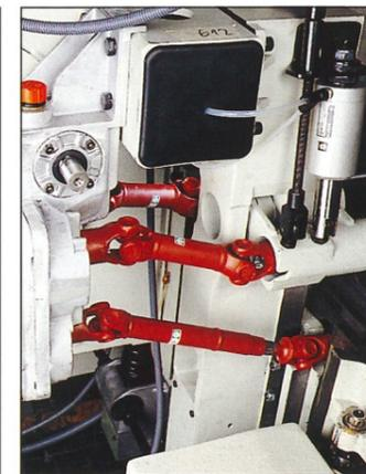
Antrieb durch Kardangelenke, nicht mit Ketten: robuster, wartungsfrei, langlebiger, genauer.
