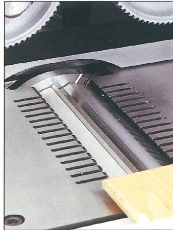
Abrichtspindel mit Falzfräser und geschlitzte Tischplatten: Präzision beim Abrichten und Fügen, Lärmschutz.
