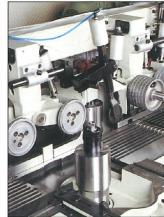
Nuten-Führsystem für gerade Fügekanten ergibt verleimfähige Werkstücke. Auch kurze, ungekappte Werkstücke werden parallel, auch verzogene genau abgerichtet, auch konische und geschwungene exakt dickengehobelt.
