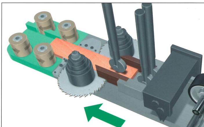
Die **Auszugseinheit** sorgt dafür, dass bei nicht kontinuierlicher Beschickung etc. das letzte Werkstück heraus transportiert wird und nicht in den Sägeblättern steckenbleibt. Dadurch werden Holzverluste vermieden und zugleich eine höhere Lebensdauer der Sägeblätter erreicht.
