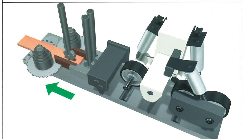
...oder ungehobeltes Rohholz. In diesem Fall wird das Werkstück in einem Durchlauf im Weinig Unimat vierseitig gehobelt und in der integrierten Spalteinheit zu Lamellen aufgetrennt.
