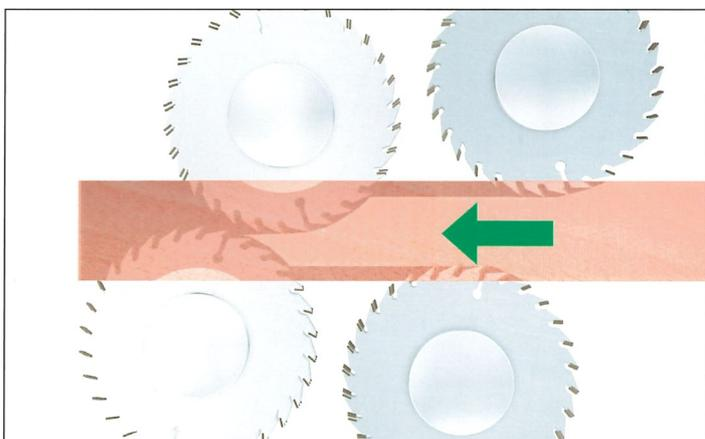
Durch den Einsatz von **Vorritzsägen** bei der Lamellenfertigung lassen sich seitliche Ausreißer durch die Trennsägen verhindern. Die Vorritzsägen haben eine Schnittbreite von nur 1,1 mm (bei Spaltsägen von 1,2 mm) und ritzen nur 7 - 10 mm tief in das Werkstück ein.
