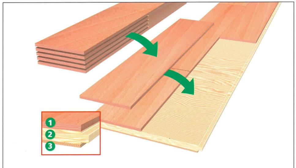
Ausgangsmaterial sind entweder vierseitig gehobelte und sortierte Werkstücke...
