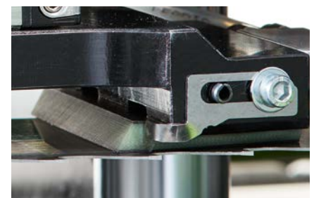
Extrem abriebfeste Hightech-Carbonführung
