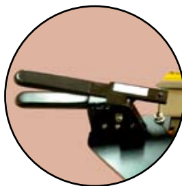
Der Bedienhebel zum Verschieben des Sägekopfes ist in einer angenehmen Höhe angebracht und leicht zu bedienen.
