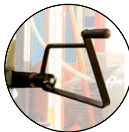
Mit einer Handkurbel heben und senken Sie den Sägekopf auf die gewünschte Höhe die auf der Skala leicht abzulesen ist.
