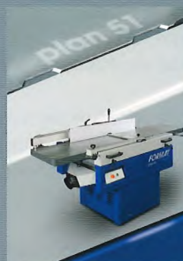
62 Una pialla a filo con un albero pialla con 4 o 6 cottelli!
