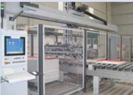
Beschickung in Portalbauweise
