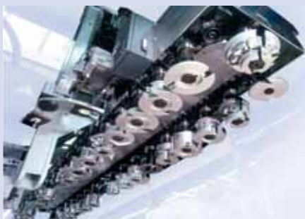
Schneller Kettenwechsler mit 30 Plätzen
