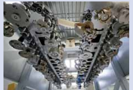
multiChain Kettenwechsler mit 144 Plätzen
