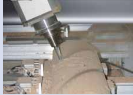
5-Achs Bearbeitung eines Krümlings
