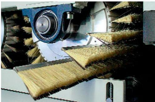
**RotoMaster** ausgestattet mit Smart-Flex Schleiflamellen.
