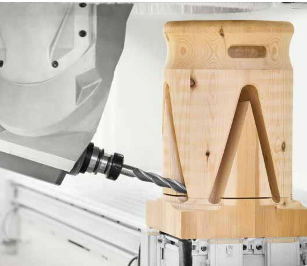
E' possibile lavorare pezzi **fino a 500 mm di altezza utile**, sia sulla faccia superiore sia sulle facce laterali, grazie all'elevata corsa dell'asse Z.
