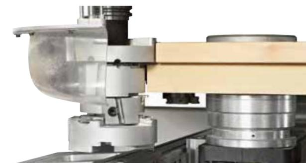
Tramite il sistema **TTS (Total Torque System)**, esclusivo SCM, l'asse rotante viene bloccato meccanicamente nelle lavorazioni ad utensile verticale, aumentando la rigidità del sistema.
