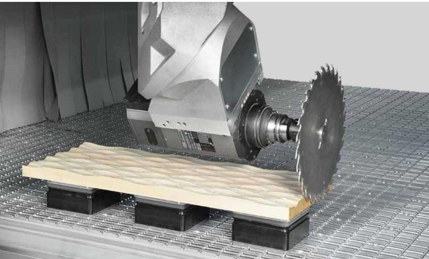
L'elettromandrino progettato e costruito da SCM, sviluppa una potenza di **17 kW** e raggiunge una velocità di rotazione massima di **24.000 g/min**. Prestazioni eccellenti che rendono la macchina ottimale **sia per fresature con grosse asportazioni di materiale sia per profilature ad alta velocità di rotazione**.
