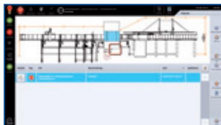
Außerdem besteht die Möglichkeit, das angezeigte Expertenwissen durch eigene Kommentare anzureichern. Die integrierte Maschinendokumentation öffnet sich automatisch an der richtigen Stelle der zugehörigen Fehlerbeschreibung. Durch die einfache und benutzerfreundliche Informationsbereitstellung ist der Bediener selbstständig in der Lage, Störungen schnell zu beheben.
