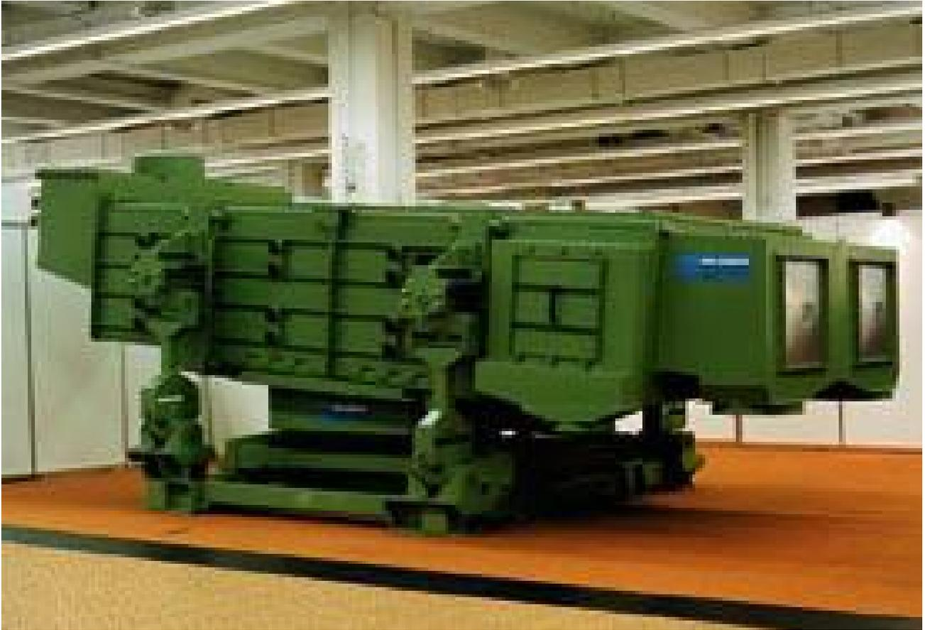
Auf der bewährten Basis der Typenreihe BSM wurde das M-System für spezielle Anwendungsgebiete praxisbezogen weiterentwickelt. Bei diesem Siebsystem wird als erste Fraktion der Staub (Feingut) abgesiebt, die Grobfraktion wird am Ende des Siebvorganges abgetrennt. Die wesentlichen Vorteile sind:
