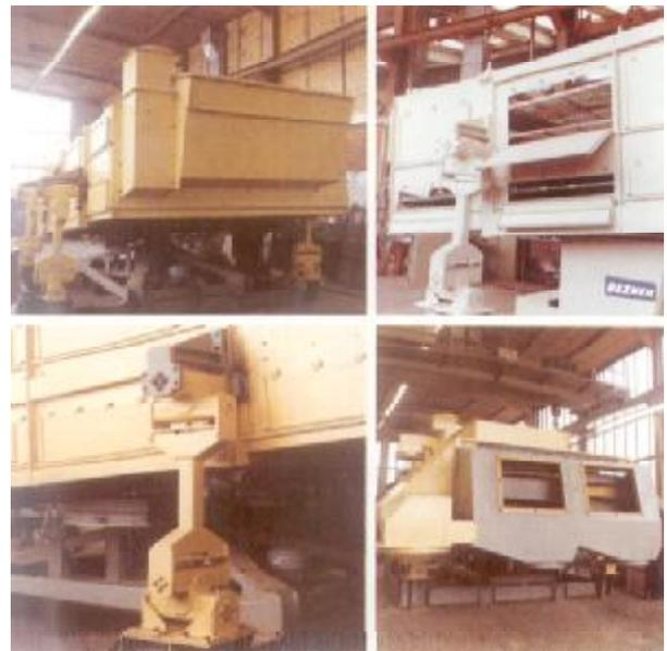
Seitlich angebrachte Siebklappen ermöglichen einen einfachen und schnellen Siebwechsel über alle Siebebenen. Erhöhten Sicherheitsanforderungen entsprechen die im Aus- und Einlauf eingebauten Berstflächen, deren Größe nach dem Siebkasten angepasst wird. Zusätzlich kann der Siebkasten zur Brandvorbeugung mit einer Sprinkleranlage ausgerüstet werden.
