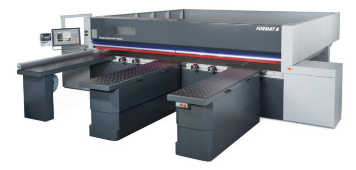
Die Plattenaufteil- und Druckbalkensäge kappa automatic classic von Format4 erfüllt die individuellen Bedürfnisse anspruchsvoller Holzbearbeiter durch effizienten Plattenzuschnitt mit bestem Preis-Leistungs-Verhältnis. Im Vergleich zu Sägen mit gleicher Schnittlänge benötigt die kappa automatic classic ganze zwei Quadratmeter weniger Aufstellfläche.
