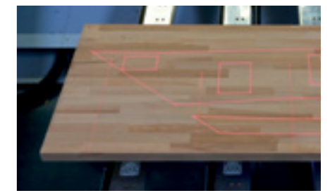
Laserprojektion der Spannmittel und der Werkstückkontur für optimale Ausnutzung und einfaches Auflegen von Rohteilen, die nicht an den Anschlägen ausgerichtet werden können.
