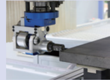
Getastetes Bündigfräsen der Kantenüberstände am Postformingprofil.
