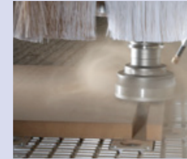
Aerotech Werkzeugaufnahme für optimale Erfassung der Späne zum Fräsen von Nuten.
