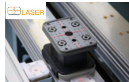
Vakuumsauger werden mit einem Laserstrahl (Fadenkreuz) angezeigt. Als Positionierhilfe für Freiformteile kann die Werkstückkontur „abgefahren“ werden.
