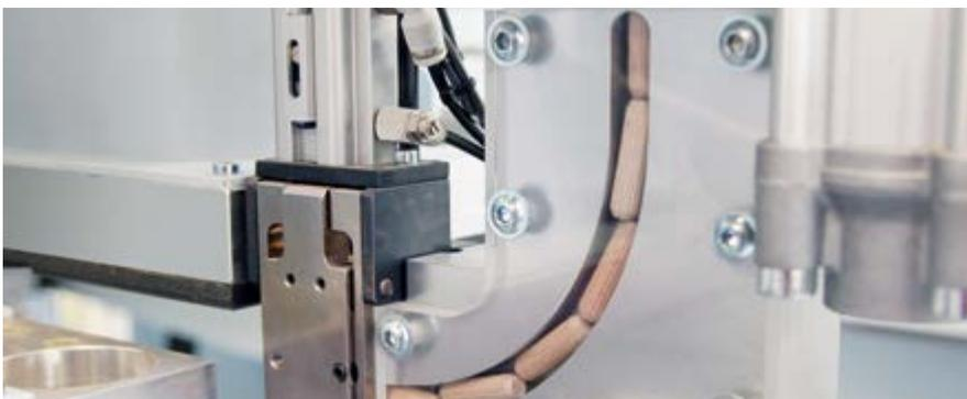
Durch die optionalen Dübeleintreibwerkzeuge ist die Flexibilität auch bei geringsten Losgrößen gesichert. Die BHX 500/D hat je ein Dübeleintreibwerkzeug an der linken und rechten Aggregateseite.
