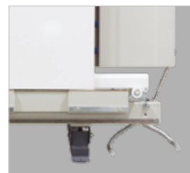
▶ Praktischer Fußhebel zum Anheben und leichteren Positionieren großer Platten auf der Säge
