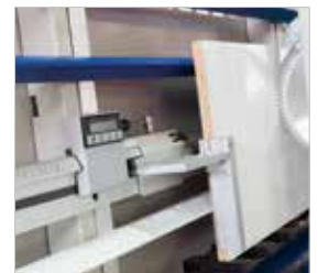
▶ Digitale Maßanzeige zur Längeneinstellung beim Vertikalschnitt
