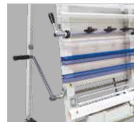
▶ Um zu verhindern, dass das Sägeblatt in eine Rückwandlatte hineinsägt, Lattenrost manuell verschiebbar
