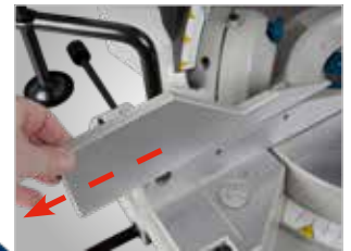
Ausziehbare Anschlagsschienen und ausziehbarer Tisch
