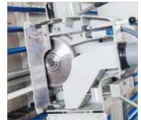
▶ Große Öffnung für Sägeblattwechsel
