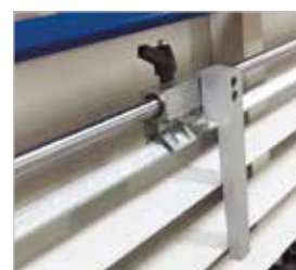
▶ Lineal zur Längeneinstellung beim Vertikalschnitt
