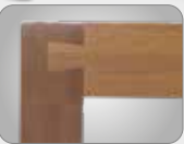
Schwalbenschwanzverzinkung in Hinterzange und Beiladerücken
