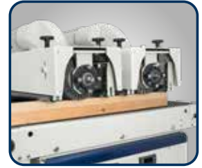
▶ Arbeitsaggregate können einzeln zugeschaltet werden
