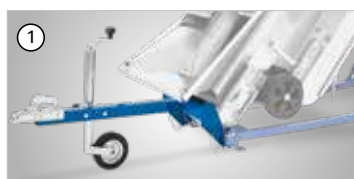
Abbildung zeigt Förderband in der Transport- und Lagerstellung
