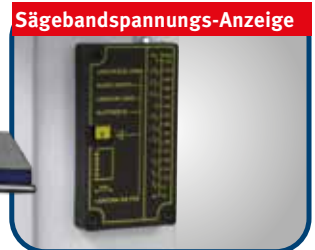
▶ Am Maschinenrahmen integrierte Anzeige der Sägebandspannung für verschiedene Bandbreiten
