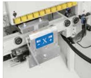
Pneumatische Spannvorrichtung für Werkstückpositionierung
