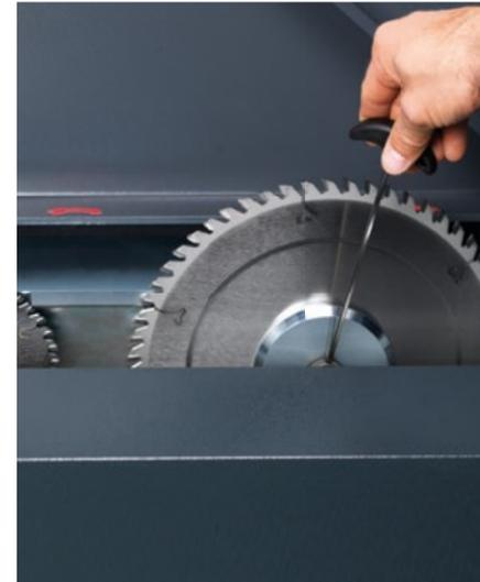
ProLock® EasyFix el cambio rápido de la lámina de corte garantiza el tiempo de montaje más corto.
