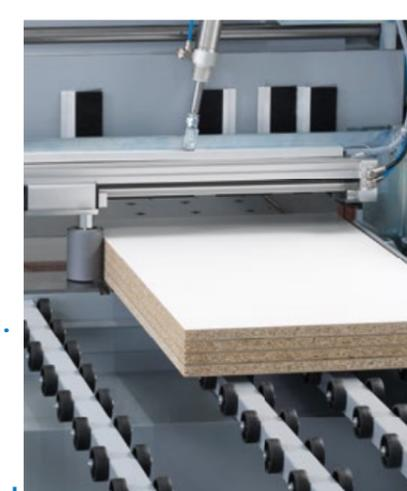
Dispositivo angular de presión para una alineación suave y precisa de los tableros.
