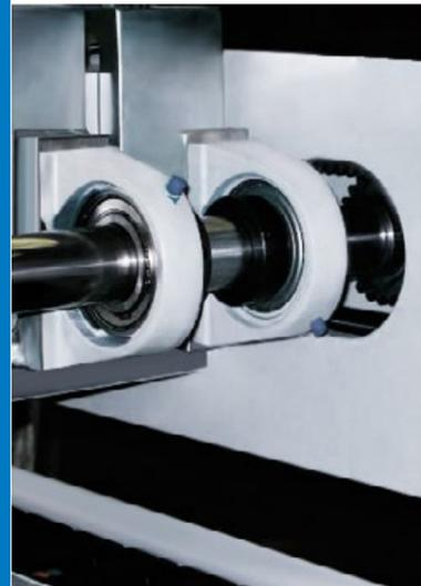
Empujador de material con servoaccionamiento AC con sistema de medición independiente para máxima precisión en las condiciones más duras.
