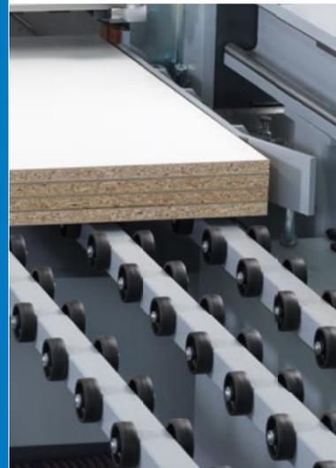
Rieles de rodillos en la mesa de soporte trasera para un manejo suave del tablero hasta la línea de corte.
