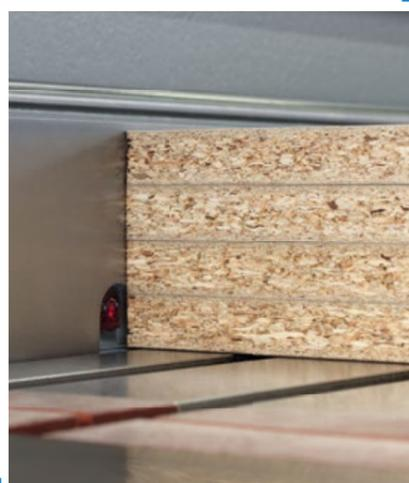
Position automática de corte: ahorro de tiempo enorme gracias a la medición automática del tamaño del tablero.
