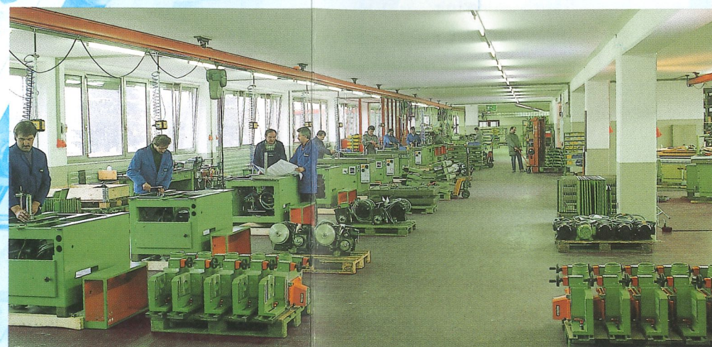
Montage der Standardtischlereimaschinen in Serie in Sigmaringen.
