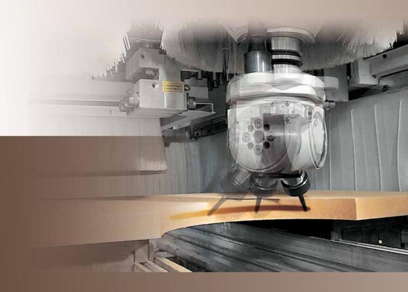
360° automatic rotation and positioning on work table 'X' - 'Y' of angular heads using digitally controlled Vector Axis managed by NC with Yaskawa Digital Motor. Drehung und automatische Positionierung der Winkelgetriebe in der X - Y Achse um 360° zum Arbeitstisch über die Vektorachse mit digitaler NC-Steuerung Yaskawa Digitalmotoren.
