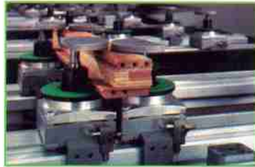
Automatische Wmspannen vom Werkstück: Lösen der inneren Spanner, Klemmen der äußeren Spanner
