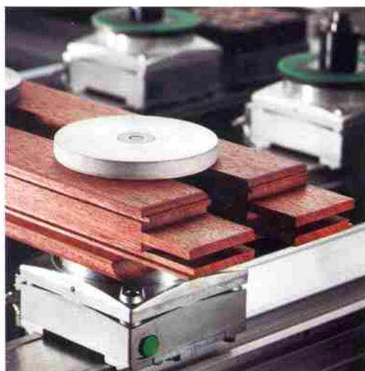
Simultantes Spannen von zwei Werkstücken mit einer Spannvorrichtung
