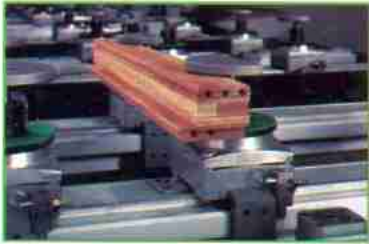
Bearbeiten der ersten Längsseite und der Stirnseite von Werkstücken
