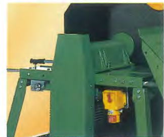
2 Mit dem Keilriemenantrieb erfolgt die Kraftübertragung auf die Sägeblattwelle sicherer. Er verhindert ein Blockieren des Motors und treibt den Holzspalter an.
