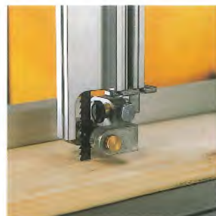
Die Präzisionsdreirollenführung führt das Bandsägeblatt optimal. Führungsrollen aus Hartmetall garantieren hohe Lebensdauer.
