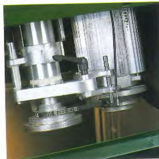
Staubdichte Frässpindelagerung aus hochwertigen Materialien.
