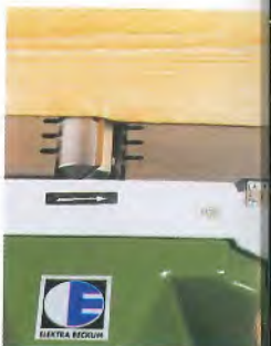
5 mm Spanabnahme in einem Arbeitsschritt.
