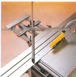
Kein Problem bei linken und rechten Gehrungen: Der variabel zu montierende Queranschlag macht's möglich.
