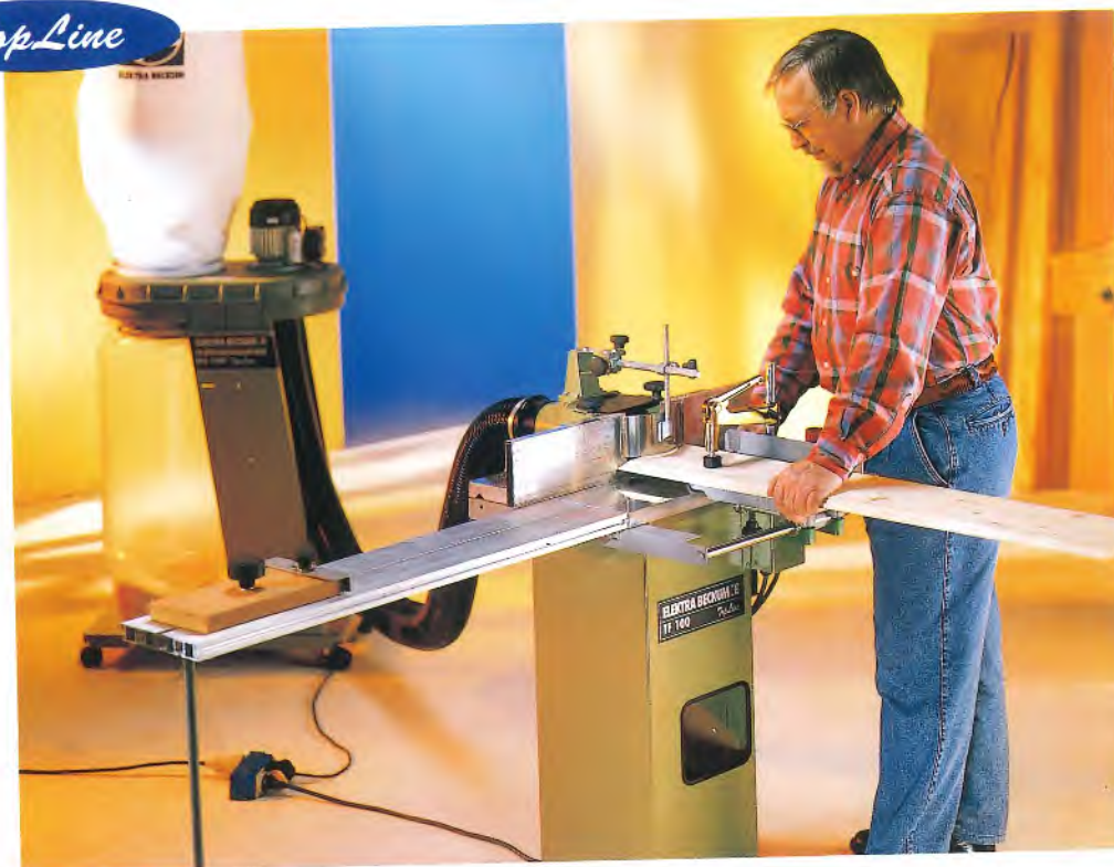
Dank der Andruckvorrichtung läßt sich jedes Werkstück sicher führen.
