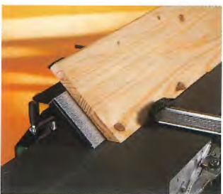
Der Abrichtanschlag ist von 90° bis 45° stufenlos schwenkbar.
