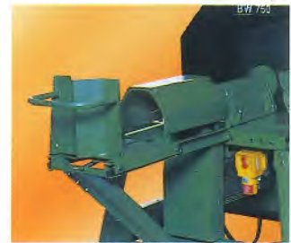
3 Erspart die Axt und müßige Arbeit: Der Holzspalter für Holzscheite von 200 - 280 mm Länge und Durchmesser von 100 - 240 mm.
