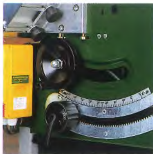
Optimale Einstellung der Schrägverstellung durch die exakte Zahnkranzführung aus Stahl.
