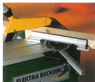
Der extragroße Universalanschlag ermöglicht Schnitte in jeder Winkelposition. Er kann an allen Seiten der Sägen angebracht werden.
