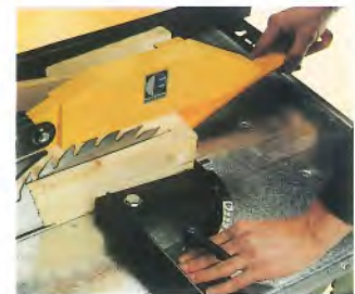
Die serienmäßige Keilschneideinrichtung ermöglicht das zügige Herstellen von Keilen.
