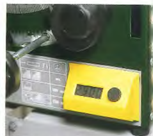
Die Drehzahl des Sägeblattes kann stufenlos eingestellt werden und wird 4-stellig digital angezeigt.
