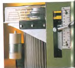
Die genaue Höhe des Fräswerkzeuges an der mm-Skala abgelesen werden.
