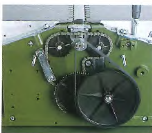
Zuverlässige Technik: wartungsfreier Antrieb von Messerwelle und Vorschub.
