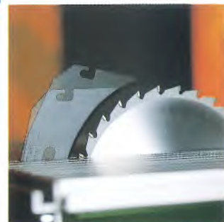
Der Spaltkeil lässt sich blitzschnell absenken, z.B. für verdeckte Schnitte.
