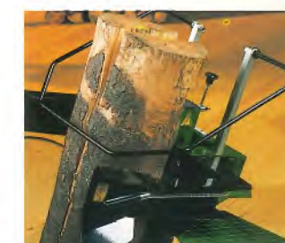
Der Sicherheitsbügel hält das gesplattene Material.
