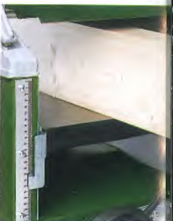
Für besonders große Werkstücke: Die Durchlaßhöhe beträgt bis 230 mm.
