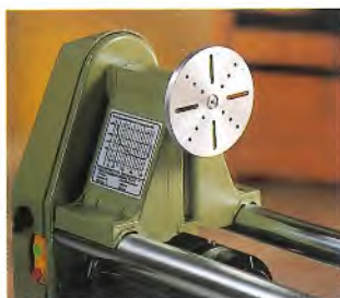
Das Maschinenbett, zwei dickwandige, verzinkte Stahlrohre, ist besonders verwindungssteif. Die Planscheibe für runde Werkstücke und Stahlaufgabe gehören zum Lieferumfang.
