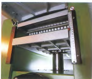
Stabile Abstützung des schweren Dickentisches.
