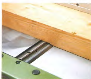
Die robusten Graugußtische sind plangefräst.
