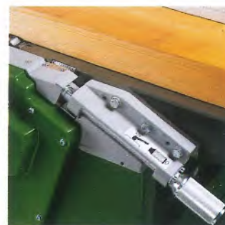
Mittels Drehgriff läßt sich die Spanabnahme ganz genau einstellen.
