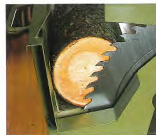
Die direkte Schnitttiefe beträgt 190 mm. Mit Wendeschnitten können Stämme bis ca. 230 mm geschnitten werden.
