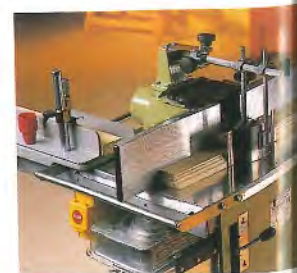
Bei Arbeiten mit dem Schiebeschlitzen (Zubehör) kann der Fräskorb einfach um 90° geschwenkt werden. Der Schiebeschlitze verbleibt somit immer an der Maschine.
