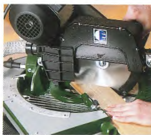
Präzise Schnitte: Möglich sind Gehrungs- und Doppelgehrungsschnitte bis 45°.
