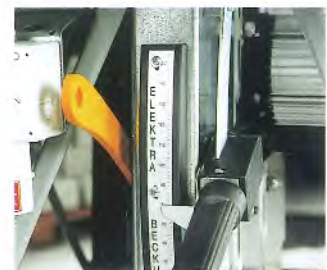
Die Einhand-Schnitthöhenverstellung mit dem patentierten „Dreh“.
