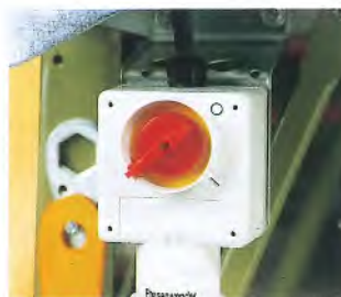
Der Phasenwandler ist bei der BKH 450 mit der 5,5 KW Motorvariante serienmäßig.
