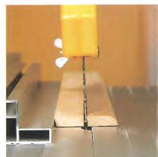
Das Hinterschneiden ist ideal zum Anpassen von Deck- und Zierleisten.
