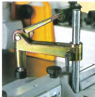
5 6 Die Exzenterspannvorrichtung mit Spannanker hält Ihr Werkstück sicher fest.
