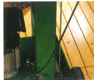
Sichere Kraftübertragung der Zwei-Hebelbedienung durch Bowdenzüge. Wartung oder Nachstellarbeiten sind nicht notwendig.
