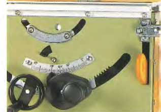
Präzise gearbeitet: Das Zahnradgetriebe sorgt für optimale Einstellung des Sägeblatts.
