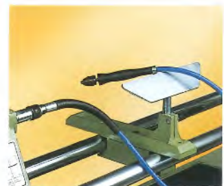
9 10 Bohrfutteraufnahme mit Zahnkranzbohrfutter, 0,5 - 10 mm. Ideale Ergänzung: Die biegsame Welle.
