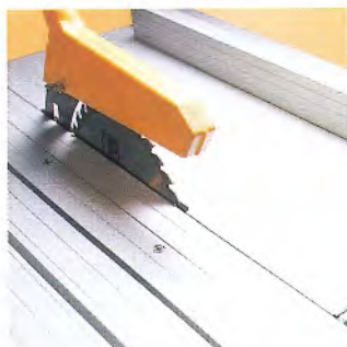
Der auf Stahlnadeln gelagerte Formatschiebeschlitten wird unmittelbar am Sägeblatt entlang geführt.
