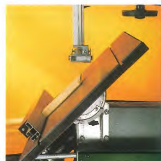
Geschweifte Teile schräg schneiden? Kein Problem mit dem schwenkbaren Arbeitstisch.
