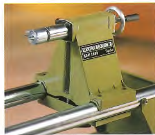
Die exakt einstellbare Pinole des Reitstockes ist mit einem Innenkonus ausgestattet, der die Aufnahme des Innenausdrehstahles und des Zahnkranzbohrfutters ermöglicht.
