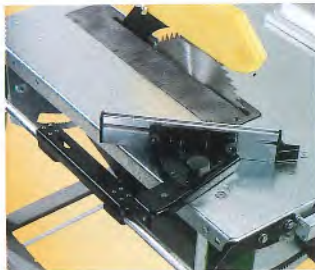
5 2 Der Winkelanschlag mit Stangenführung ist serienmäßig.
