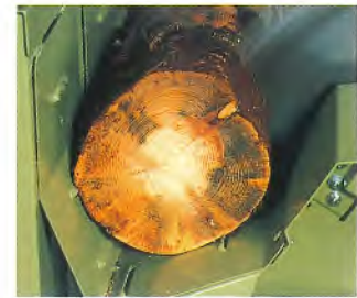
Direkte Schnitttiefe: 240 mm. Stark ausgeprägte Haltekralle fixieren das Schnittgut fest und sicher.
