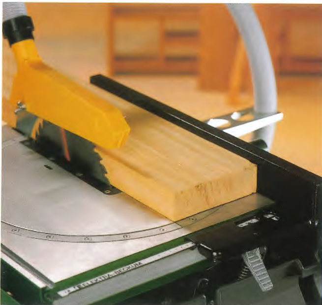
Die stufenlos einstellbare Schnitthöhe bis 81 mm ermöglicht die vielseitigsten Arbeiten.
