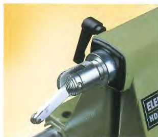
11 Wenn's in die Tiefe geht: Der Innenausdrehstahl. Bohrtiefe max. 100 mm, Bohrdurchmesser max. 80 mm.
