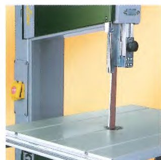
3 Mit der Bandschleifeinrichtung können Schnittflächen optimal nachbearbeitet werden.
