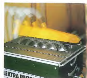
Ziehen statt schieben: Das Sägeblatt wird durch das Werkstück gezogen.
