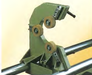
12 Zur Bearbeitung langer und dünner Werkstücke ist die Lünette unentbehrlich.
