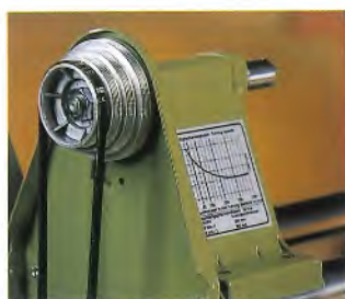
Der Riemenantrieb ist besonders langlebig und geräuscharm da kein einfacher Keilriemen, sondern ein Rippenband verwendet wird.
