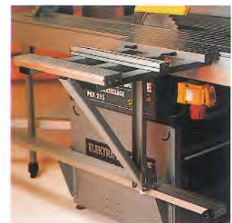
Noch mehr Bearbeitungsmöglichkeiten mit dem soliden Querwagen.
