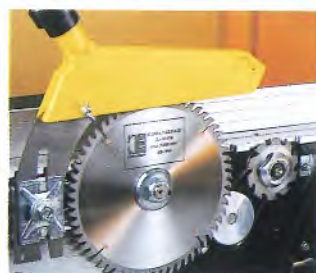
1 Das gegenläufige Vorritzsägeblatt wird von einem eigenen Motor angetrieben.
