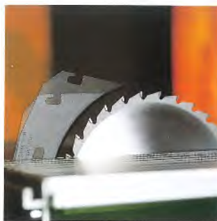
Ideal für verdeckte Schnitte ist der absenkbare Spaltkeil.
