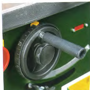
Präzise Höheneinstellung: Feinjustierung mit „0-Rückstellung“.
