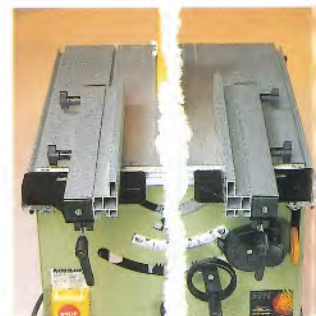
Der Parallelanschlag ist rechts- und links einsetzbar. Besonders vorteilhaft bei 45° Schnitten.
