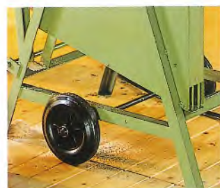
1 Das serienmäßige Fahrgestell der BW 600 empfiehlt sich als Zubehör auch für die BW 500 für den mobilen Einsatz.
