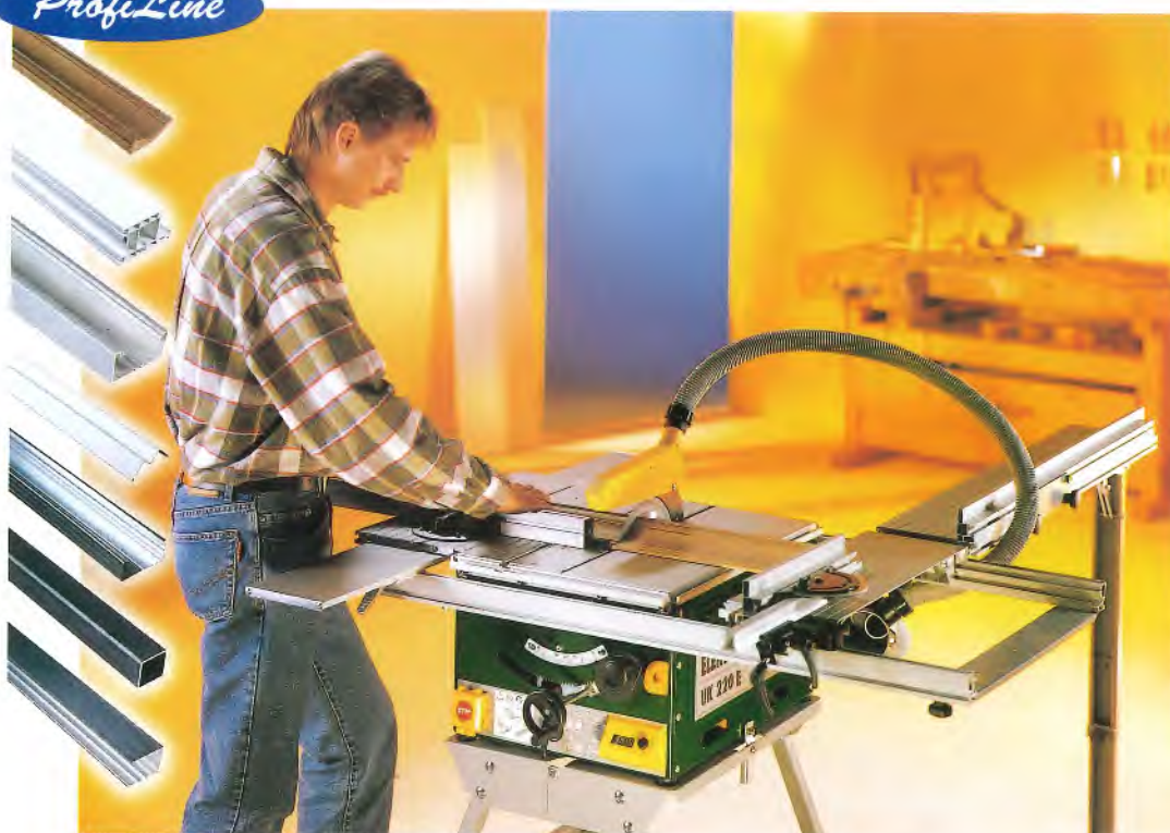
Die Drehzahl des Sägeblattes kann stufenlos eingestellt werden und wird 4-stellig digital angezeigt.
