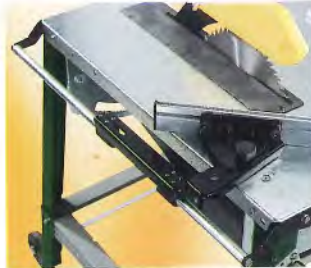
Der serienmäßige Schiebeschlitzen der TKHS 315 ist abschwengbar.
