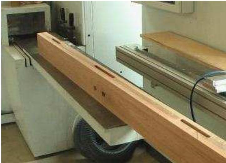
Haustürprofile können mit dem Längsanschlag in drei Bearbeitungszyklen bearbeitet werden.
