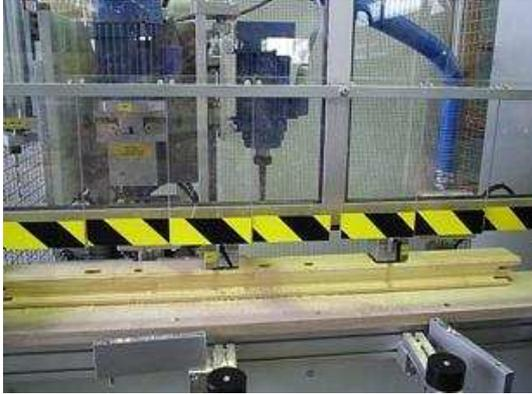
***Fräsaggregat vertikal von oben***
