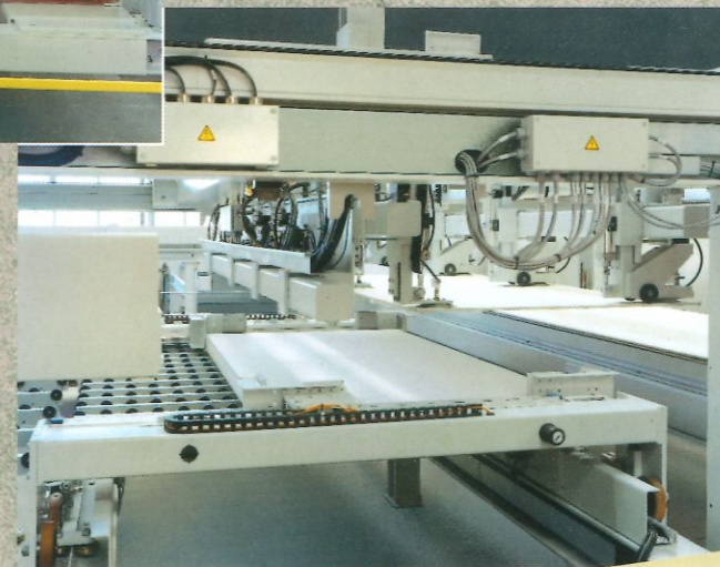
Vorstapeltisch mit automatischer Längs- und Querausrichtung Prestacking table with automatic length and cross alignment Table d'empilage avec dispositif automatique pour le cadrage en sens longitudinal et transversal Mesa pre-estibadora con alineación automática en el sentido longitudinal y transversal Tavolo di preaccatastamento con allineamento longitudinale e trasversale automatico
