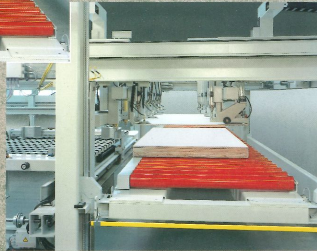
Vereinzelung der Platten durch Spezial-Vakuum-System Separation of panels by special vacuum system Décollage des panneaux grâce à un système spécial à ventouses Separación de los tableros mediante sistema especial de ventosas Singolarizzazione dei pannelli con sistema a depressione speciale
