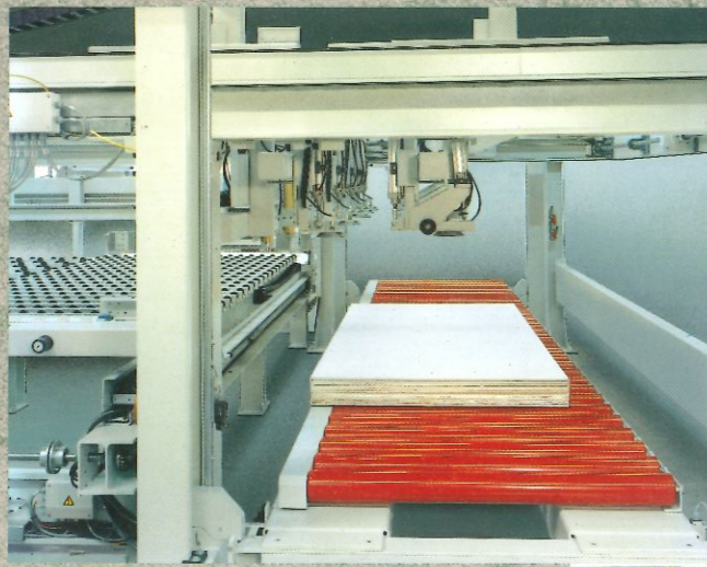
Stapeleinlauf über hydraulischen Vier-Säulen-Hubtisch mit Rollen Feeding of panel stacks via hydraulic four-column lift with rollers Alimentation de piles par table élévatrice à 4 colonnes hydrauliques, équipée de rouleaux Alimentación de pilas mediante mesa elevadora hidráulica de cuatro columnas, con rodillos Introduzione della catasta con elevatore idraulico a 4 colonne con rulli
