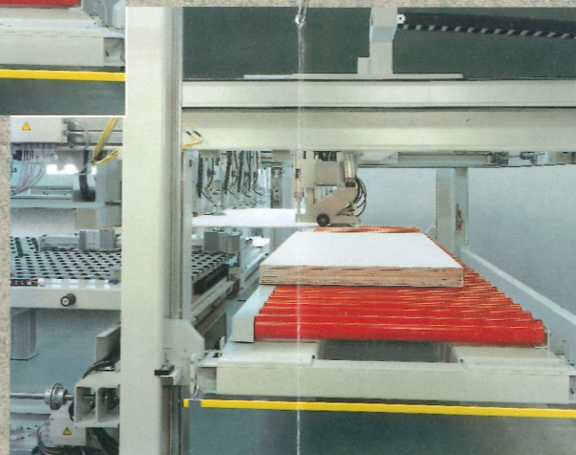
Hochleistungsbeschickung von Einzelplatten High performance feeding system for single panels Haut niveau de performances pour l'alimentation de panneaux unitaires Alimentación de alto rendimiento de tableros individuales Caricatore ad alto rendimento per pannelli singoli
