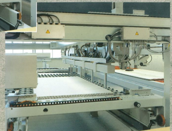
Transport des ausgerichteten Paketes zur Längssäge Transport of the aligned book towards the rip saw Transport des panneaux au préalable cadrés, vers la scie longitudinale Transporte del paquete alineado a la sierra longitudinal Trasporto del pacco allineato verso la sega longitudinale
