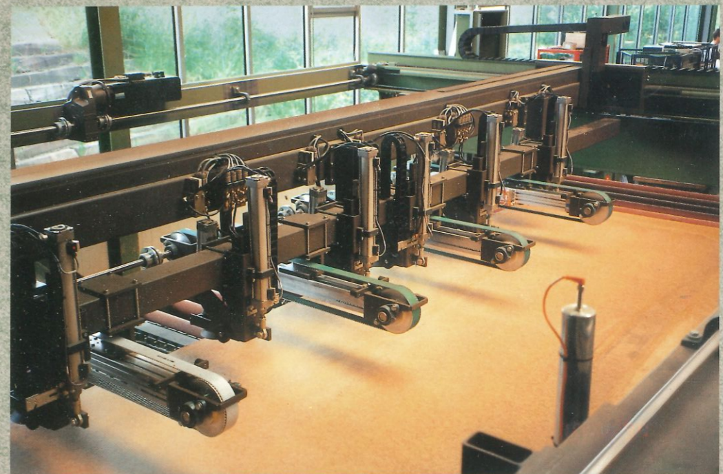
Hochleistungsbeschickung von Einzelplatten High performance feeding system for single panels Haut niveau de performances pour l'alimentation de panneaux unitaires Alimentación de alto rendimiento de tableros individuales Caricatore ad alto rendimento per pannelli singoli
