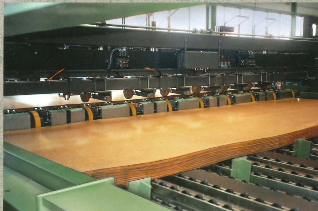
Patentierter HOLZMA Walzenbeschleuniger für dünnes Plattenmaterial und anschließendem Vorstapeltisch mit Längs- und Querausrichtung Patented HOLZMA nip roller for thin panels and subsequent prestacking table with length and cross alignment Dispositif de rouleaux accélérateurs sous brevet HOLZMA pour panneaux minces, relié à une table d'empilage équipée de systèmes de cadrage en sens longitudinal et transversal Accelerador patentado de rodillos HOLZMA, para alimentar tableros delgados, y mesa pre-estibadora con alineación longitudinal y transversal Dispositivo di accelerazione dei rulli Brevetto HOLZMA per pannelli sottili con annesso tavolo di preaccatastamento con allineamento longitudinale e trasversale
