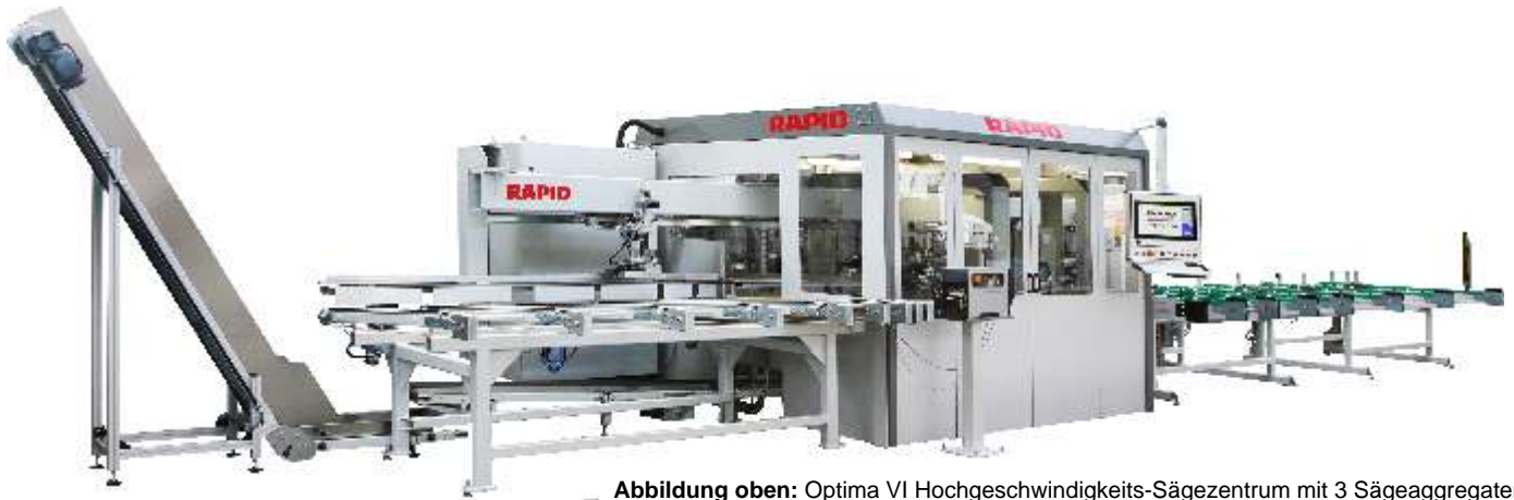
Abbildung oben: Optima VI Hochgeschwindigkeits-Sägezentrum mit 3 Sägeaggregaten. Abbildung unten: Draufsicht Optima VIA Inline mit M-Modul und Pufferstation Rechtszufuhr.
