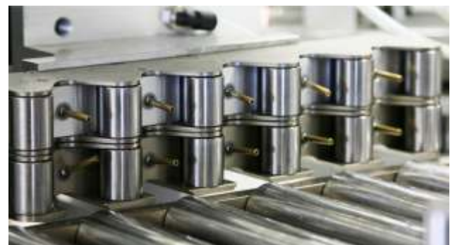
Aluspäne wird von geschliffenen Profilauflagen weggeblasen
