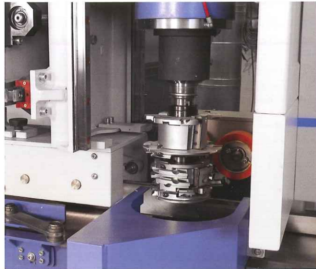
Profilierspindeln arbeiten von beiden Seiten
