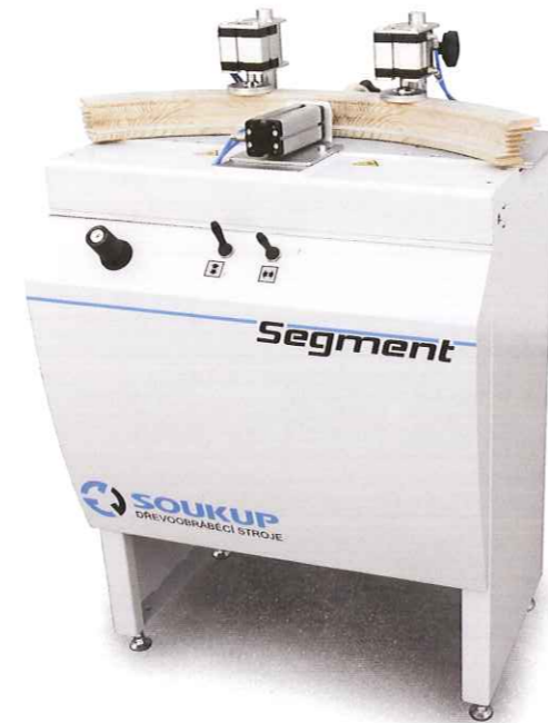
Die pneumatische Segmentpresse vereinfacht die Verbindung der bearbeiteten Teile.
