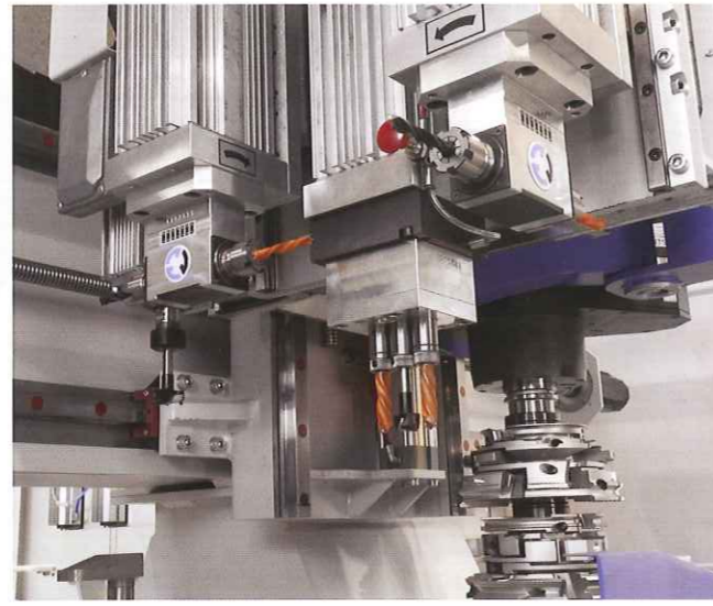
Zapfenschneidespindel mit Bohreinheiten
