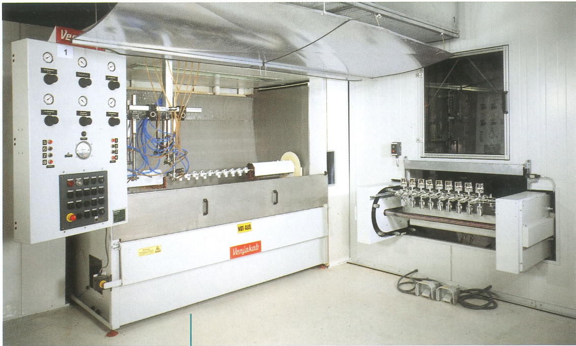
Spindelautomat (links) zur Beschichtung von zylindrischen Hohlkörpern, in Kombination mit einem Hochtrockner
