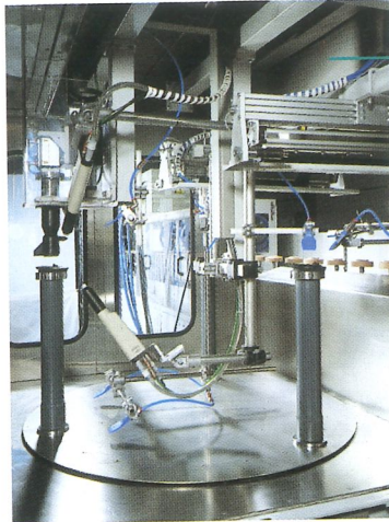
Teilansicht: Pulverbeschichtungsanlage mit automatischer Werkstückzuführung
