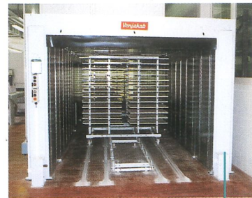
Hordenwagentrockner, quer beschickt, in Kombination mit einem Schubstangenfördersystem
