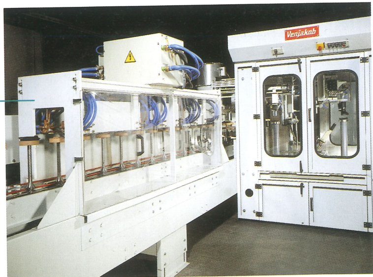
Pulverbeschichtungsanlage für Gummi-Metalteile mit nachfolgender Induktionshärtung
