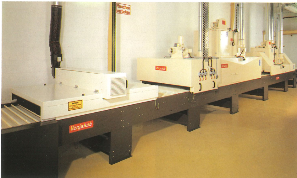
Four de séchage par UV / Zone infra-rouge / tunnel à tuyères / tunnel d'évaporation.
