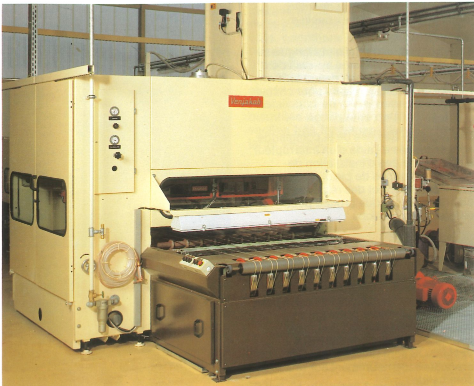
Robot de pistolage RS 8 avec système de transport à bandes d'acier.
