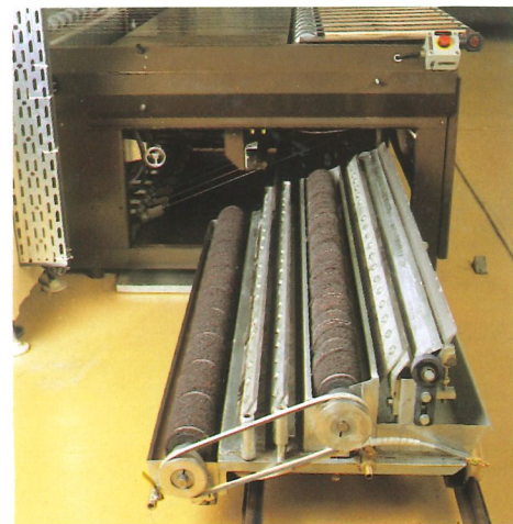
Robot de pistolage RS 8 avec système de transport à bandes d'acier.
