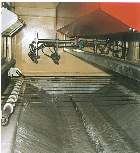
◀ Vue intérieure dans la cabine de pistolage équipée de transporteur à bandes d'acier, système d'aspiration à rideau d'eau, 4-faces du type VAE.
