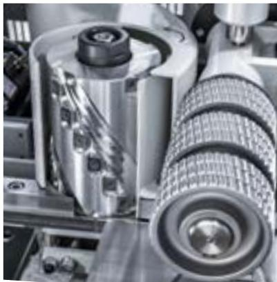
Spiralna glava, opremljena pločicama otpornim na habanje je savršena za predblanjanje i obradu tvrdog drveta.
