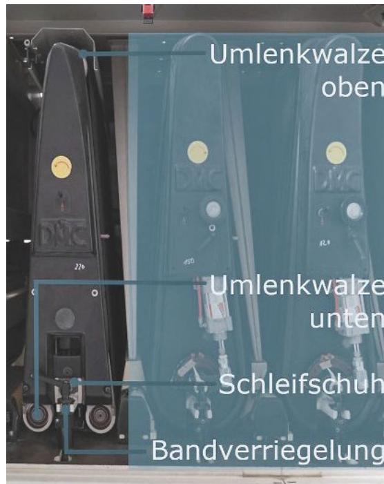
Aufbau eines Schleifschuhaggregates
