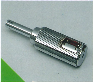
Particolare del rullo sezionato. Detail of the sectional in-feed roller. Détail du rouleau sectionné. Detail des Gliederdruckbalkens. Detalle del rodillo seccionado.
