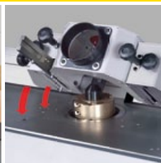
Das MULTI- Einstellsystem mit Parallelführung und Schnelleinstellung
