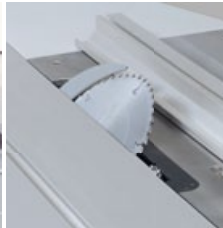
Sägeblatt schwenkbar von 90°–45°
