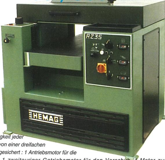
Die Selbständigkeit jeder Funktion wird von einer dreifachen Motorisierung gesichert : 1 Antriebsmotor für die Messerwelle. 1 zweitouriger Getriebemotor für den Vorschub. 1 Motor zur Höhenverstellung des Tisches.
