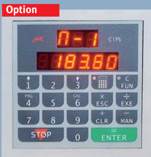
• Option Elektronische Dickentischpositionierung über Tastatur mit Inkremental- und Taschenrechnerfunktion PS 630
