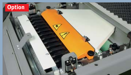
• Abb. zeigt Option "Pneumatische Druckeinstellung der oberen Vorschubwalzen" für PS 630
