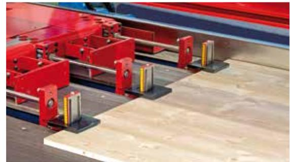
Zur einfachen Identifikation lassen sich die Bauteile auch markieren und beschriften. Die fertig bearbeiteten Werkstücke werden automatisch auf den Ablagehubtisch gestapelt und können als Paket abgenommen werden. Für einen einfachen Weitertransport ist auch das Arbeiten mit Stegen möglich, die der Bearbeiter bei der Endmontage durchtrennt.
