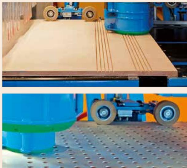
Fabrication économique de profils acoustiques à l'aide d'une tête multibroches ou d'outils spéciaux.
