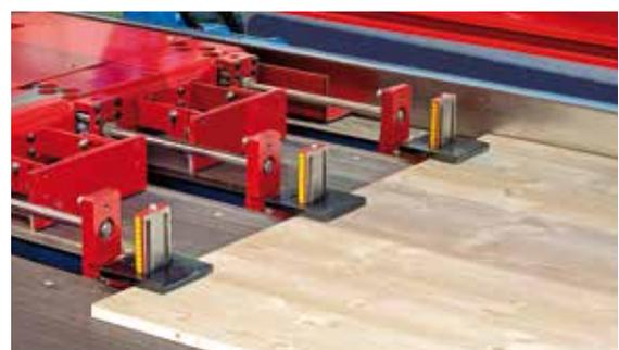
Les pièces peuvent également être marquées et étiquetées pour être facilement identifiées. Les pièces usinées sont empilées automatiquement sur la table élévatrice et peuvent être extraites par paquets. Pour faciliter le transport, il est également possible de travailler avec des entretoises que l'opérateur sépare au moment du montage final.
