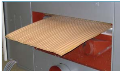
K34G-OUR zum gleichzeitigen Auftrennen und Profilieren von Bettfederleisten
