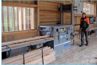
KME2-750 mit manueller Beschickung im Sägewerk
