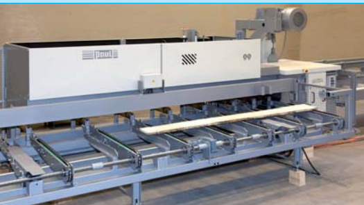
Vollautomatische Beschickung AB920 in Kombination mit einer KME3-1012 mit oben liegendem Motor
