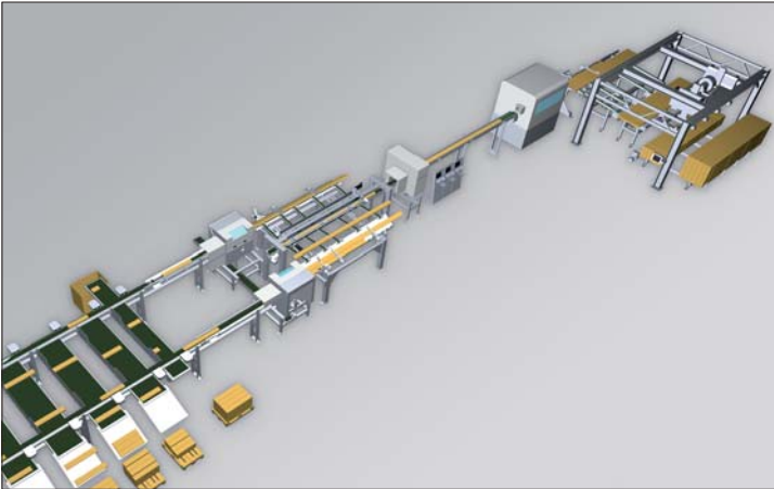
Doppelkapplinie mit Vakuum-Entstapelung, Hobelmaschine, Scanner, zwei Kapstationen, Sortieranlage und Mechanisierungskomponenten
