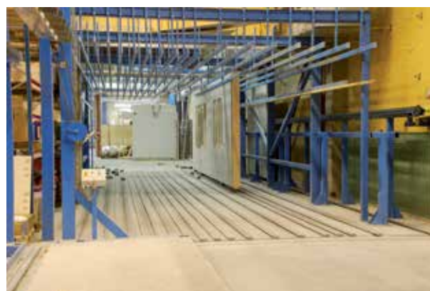
Vy över vertikalt lagersystem. Kan matas direkt från BS20-system vid option BS2-RVP.
