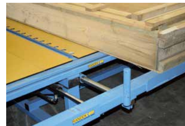
Vy över hydraulisk bredd- och uppriktningssfunktion (BS2-HW3100HS)
