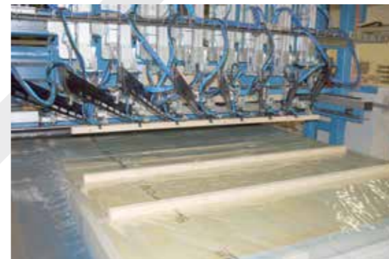
Positionierung und Nagelung eines Extra-Rahmenwerkes
