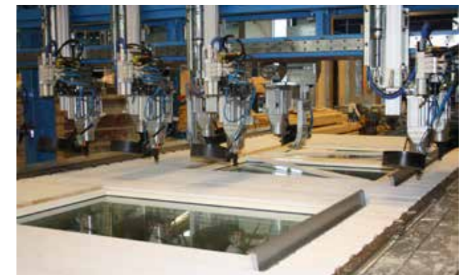
Die Nageldrucker arbeiten um Bruchteile von Sekunden asynchron, um nicht zu große Nagelpresskräfte gleichzeitig auf das Element einwirken zu lassen, und das bei dennoch hoher Leistungsfähigkeit.
