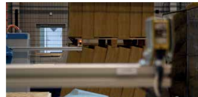
Lichtschranken stellen sicher, dass nur das Wandelement in die Maschine transportiert wird.
