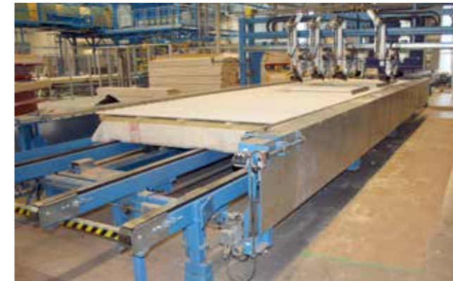
Nageltisch NTC3000, ausgerüstet mit Verkleidungsschablone, einstellbar in x-, y und z-Richtung. Die Schablonen können ganz leicht ausgetauscht werden.
