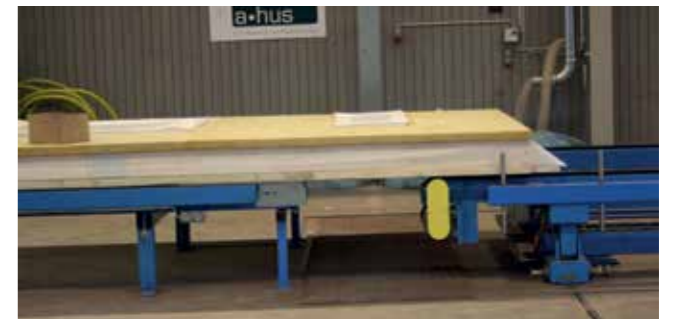
Sicherheitsschaltmatten zwischen den Stationen verhindern, dass Werker zwischen Station und Wandelement eingeklemmt werden.
