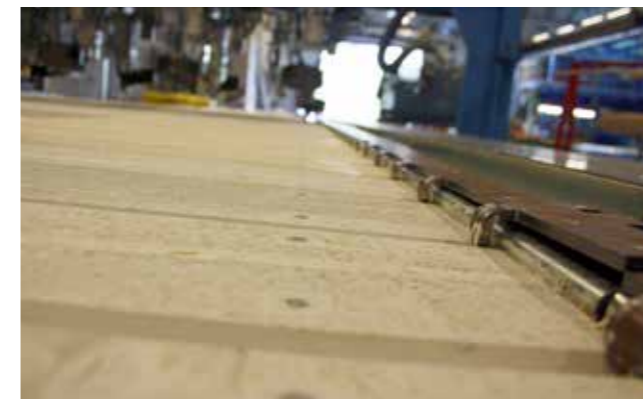
Die Verkleidungsschablone ermöglicht exaktes Auflegen der Verkleidungsbretter und die Nageldrucker drücken die Nägel im großen Unterschied zu herkömmlichen Nagelpistolen gleichmäßig tief ein.
