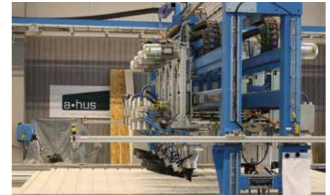
Nagelbrücke mit 8 Nageldrücken für große Kapazität und mit Lattenausrichteinrichtung für exakte Positionierung der Verkleidung.
