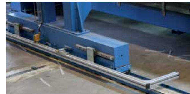
Not-Stopp-Schaltleisten verhindern Unfälle, wenn sich die Nagelbrücke bewegt.
