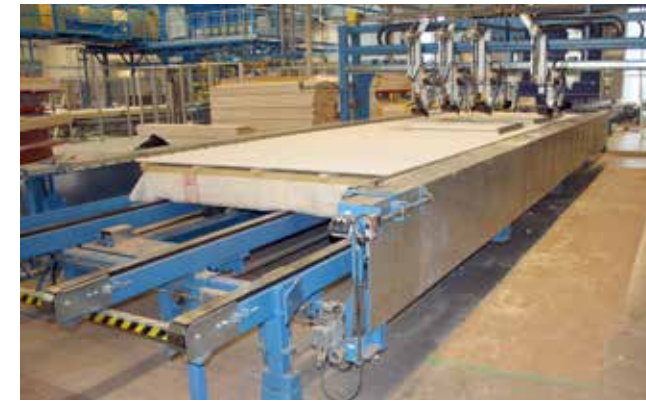
Underrede NTC3000 utrustad med panelmall inställningsbar i x-, y och z-led. Mallen är utbytningsbar.
