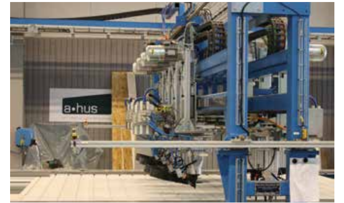
Portalen utrustas med 4 x 2 spiktryckare för hög kapacitet samt läktuppriktare för spikning av lockläkt.
