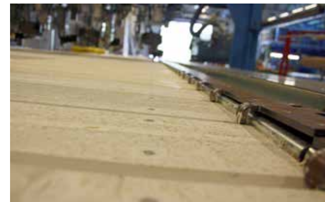
Panelmallen gör att placeringen av panelen blir exakt och spiktryckare trycker i spiken till exakt djup till skillnad om man spikar med spikpistol.
