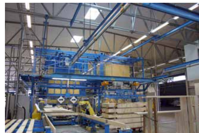
Vy över regelverksstation FM3000 utrustad med världens mest avancerade system för isolerhantering.
