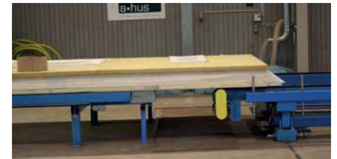
Trappmattor mellan stationerna förhindrar operatörer att befinna sig mellan maskinerna vid vägtransport.
