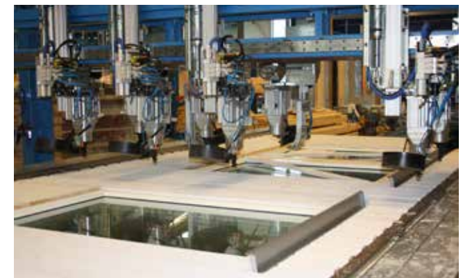
Avfyrningen av spiktryckarna görs med en liten förskjutning tidsmässigt i syfte att skona regelverket.
