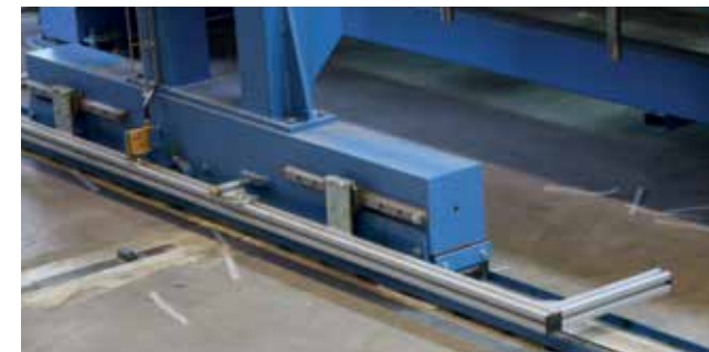
Påkörningsskydd minimerar riskerna för personskador när portalen förflyttar sig.
