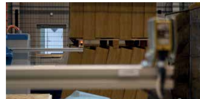
Ljusbommar säkerställer att endast väggen transporteras in i maskinen.
