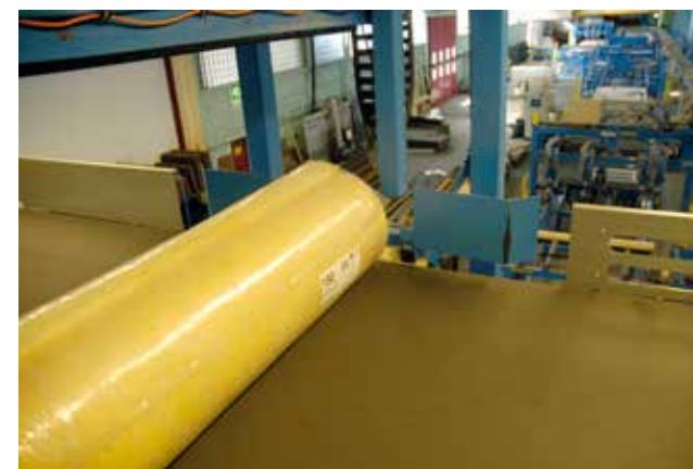
Isolerhanteringssystemet kan även hantera runda balar.
