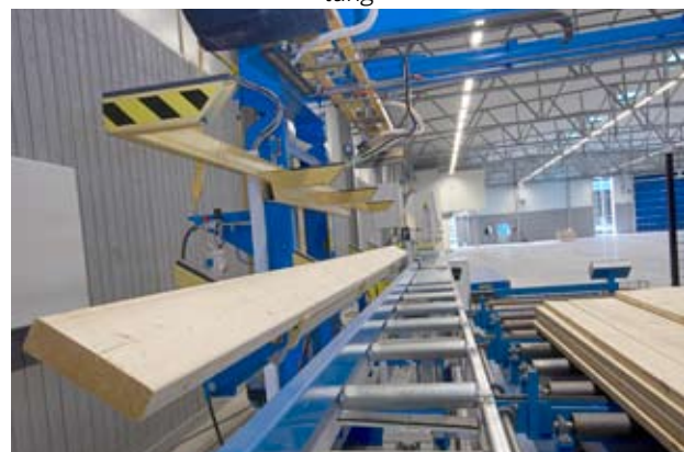
Brett, kurz vor dem Ablegen auf der Zuführbank mit Rollenbahn
