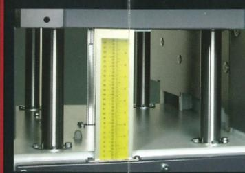
Elektrische Höhenverstellung des Dickentisches und digitale Anzeige der Werkstückhöhe. Den Knopf gedrückt halten, wenn eine schnelle Bewegung gewünscht wird. Bei Feineinstellung, den Knopf kurz antippen. Genauigkeit bis auf 1/10mm.
